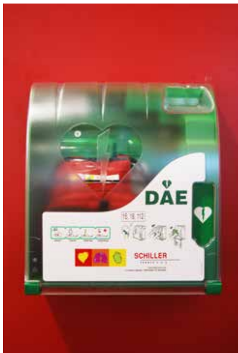
Un défibrillateur automatisé externe (DAE) est un appareil qui analyse le rythme cardiaque et décide si un choc électrique doit être délivré pour rétablir l'activité du cœur.
